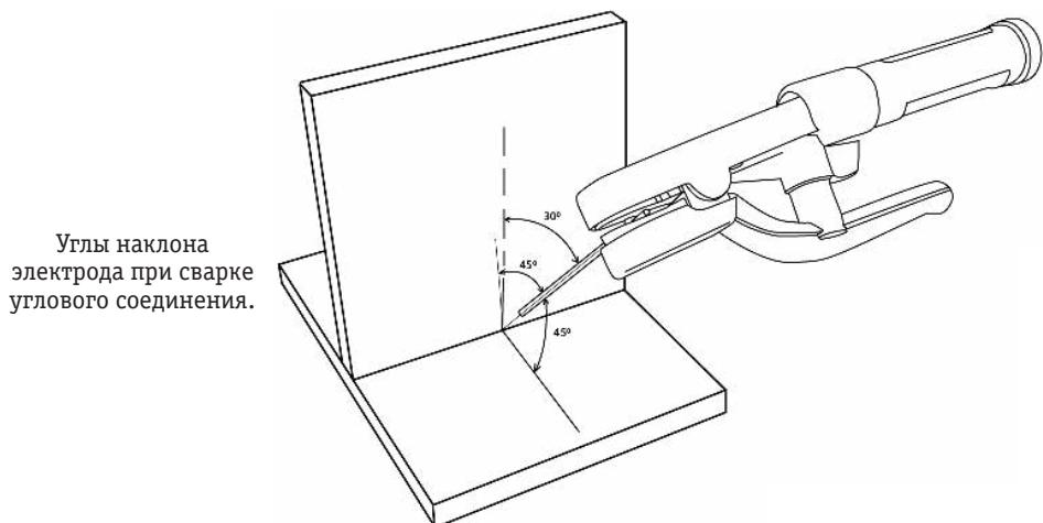
Рис. 10.5. Угол наклона электрода.
