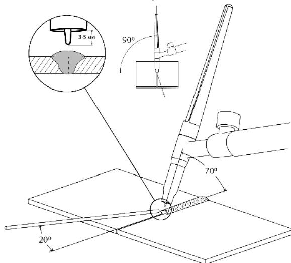
Рис. 12.15. Стыковое соединение.
