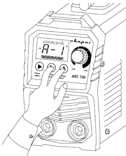
Аппарат позволяет включать/выключать данную функцию. По умолчанию Antistick включен (См. рис. 7.6). Для включения/выключения необходимо зажать и держать кнопки выбора диаметра электрода и параметров сварки в течение 3-х секунд.
