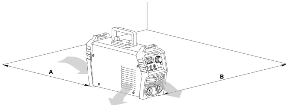
Рис. 8.3. Установка оборудования от стен.
