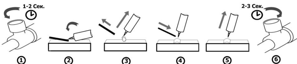
Рис. 12.11. Способ поджига дуги от присадочного прутка.
