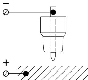
Рис. 12.1. Полярность при TIG сварке.
