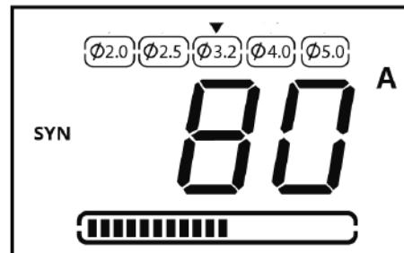
Рис. 9.9. Диаметр электрода выбран.
