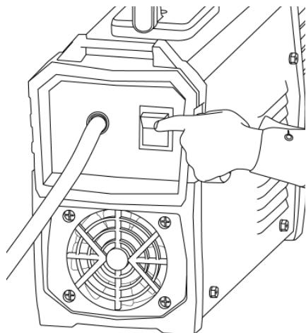
**3.** Включите сварочный аппарат (См. рис. 9.4).
