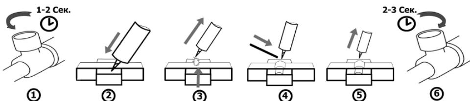
Рис. 12.12. Способ поджига дуги на выводной пластине.
