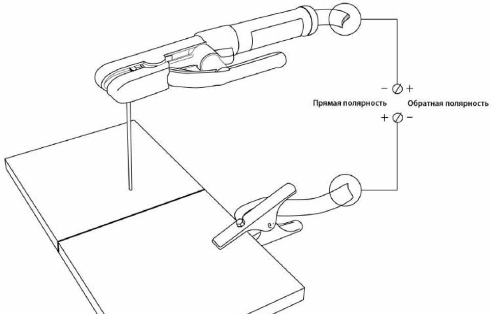
Рис.10.6. Способы подключения.
