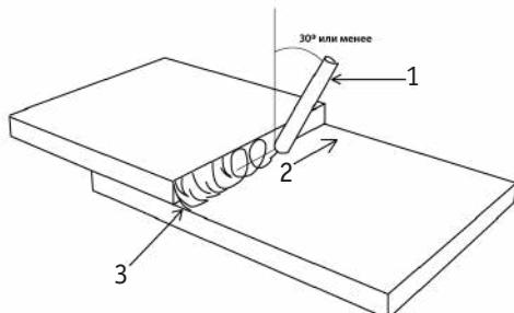
Сварка в два и более проходов
