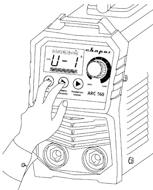
Аппарат позволяет включать/выключать данную функцию. По умолчанию VRD выключен. Для включения/выключения необходимо зажать и держать кнопки выбора режима сварки и диаметра электрода в течение 3-х секунд (См. рис. 7.7).
