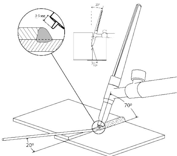
Рис. 12.16. Нахлесточное соединение.
