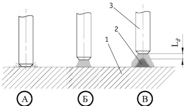
Рис. 10.2. Схема образования дуги:
