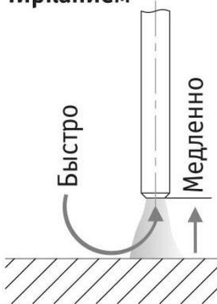
Рис. 10.1. Способы зажигания сварочной дуги.
